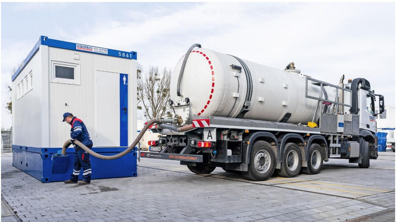
Auch unsere Sanitärcontainer können unabhängig von einem Abwasseranschluss an den verschiedensten Standorten aufgestellt und installiert werden. Um sicherzustellen, dass auch in solchen Situationen eine umwelt- und fachgerechte Abwasserentsorgung gewährleistet ist, setzen wir auf den Einsatz unserer modernen Saugfahrzeuge.
